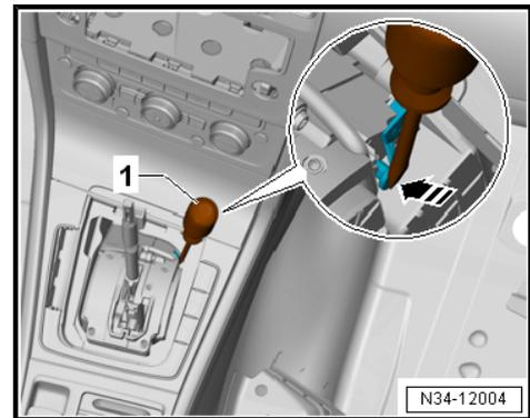
Der Wählhebel kann jetzt aus Stellung »P« herausgeschaltet werden.
