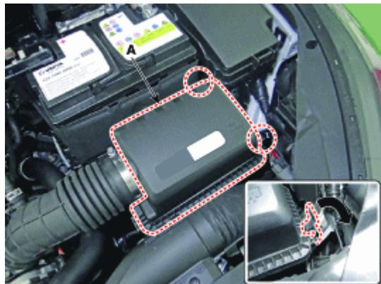
2. Luftfiltereinsatz (A) durch einen neuen ersetzen.
