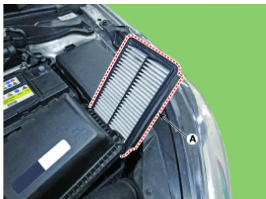
3. Luftfilterabdeckung anbringen und mit den Klammern befestigen.
