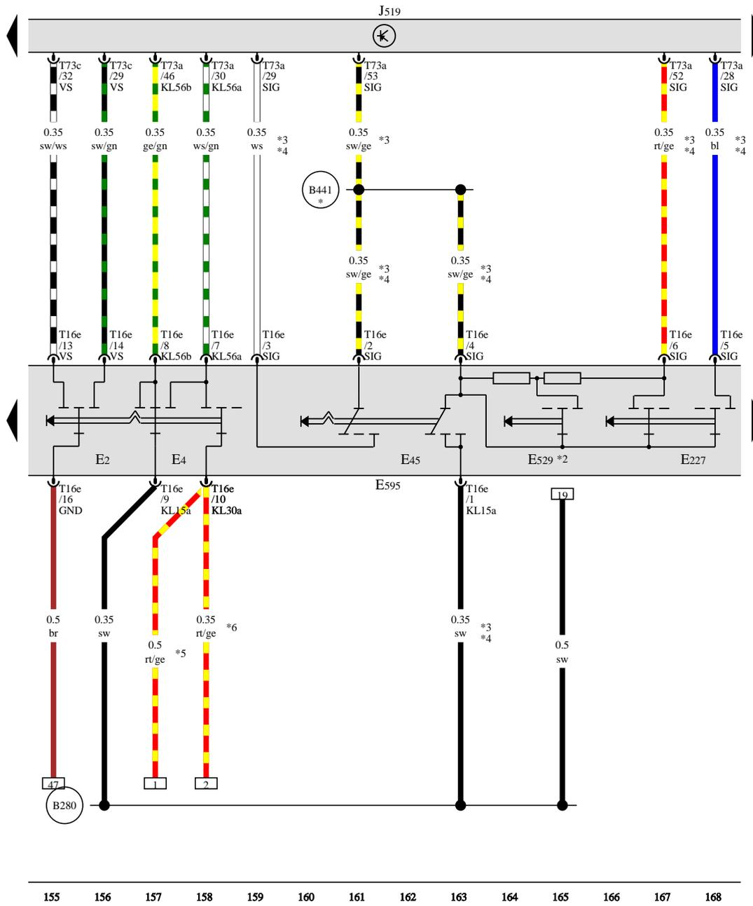
Blinklichtschalter, Schalter für Handabblendung und Lichthupe, Schalter für GRA, SET-Taster für GRA, Taster für Wiederaufnahme der gespeicherten Fahrgeschwindigkeit, Lenkstockkombinationsschalter, Bordnetzsteuergerät
