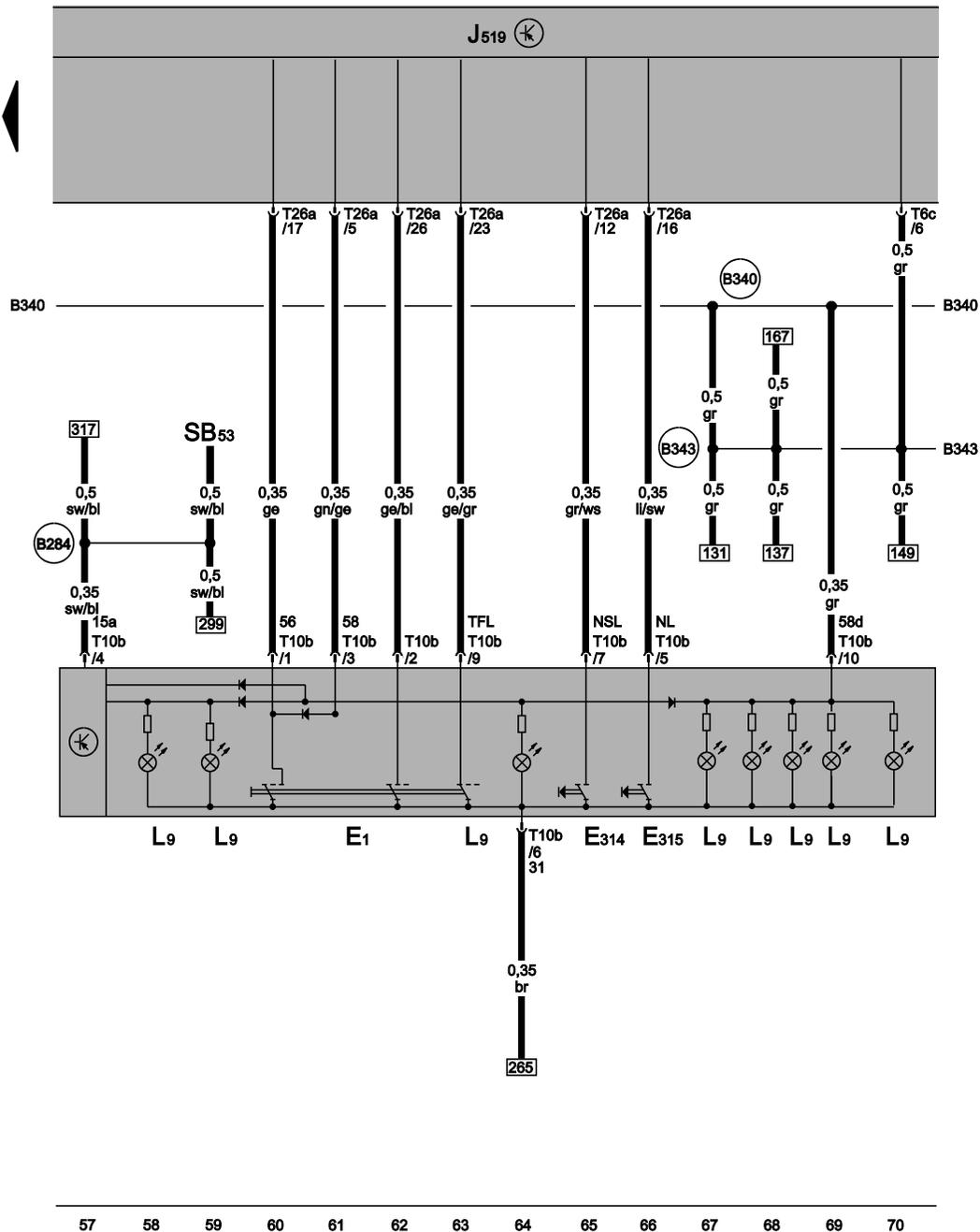
**Bordnetzsteuergerät, Lichtschalter, Taster für Nebelscheinwerfer, Taster für Nebelschlussleuchten, Lampe für Lichtschalterbeleuchtung**
