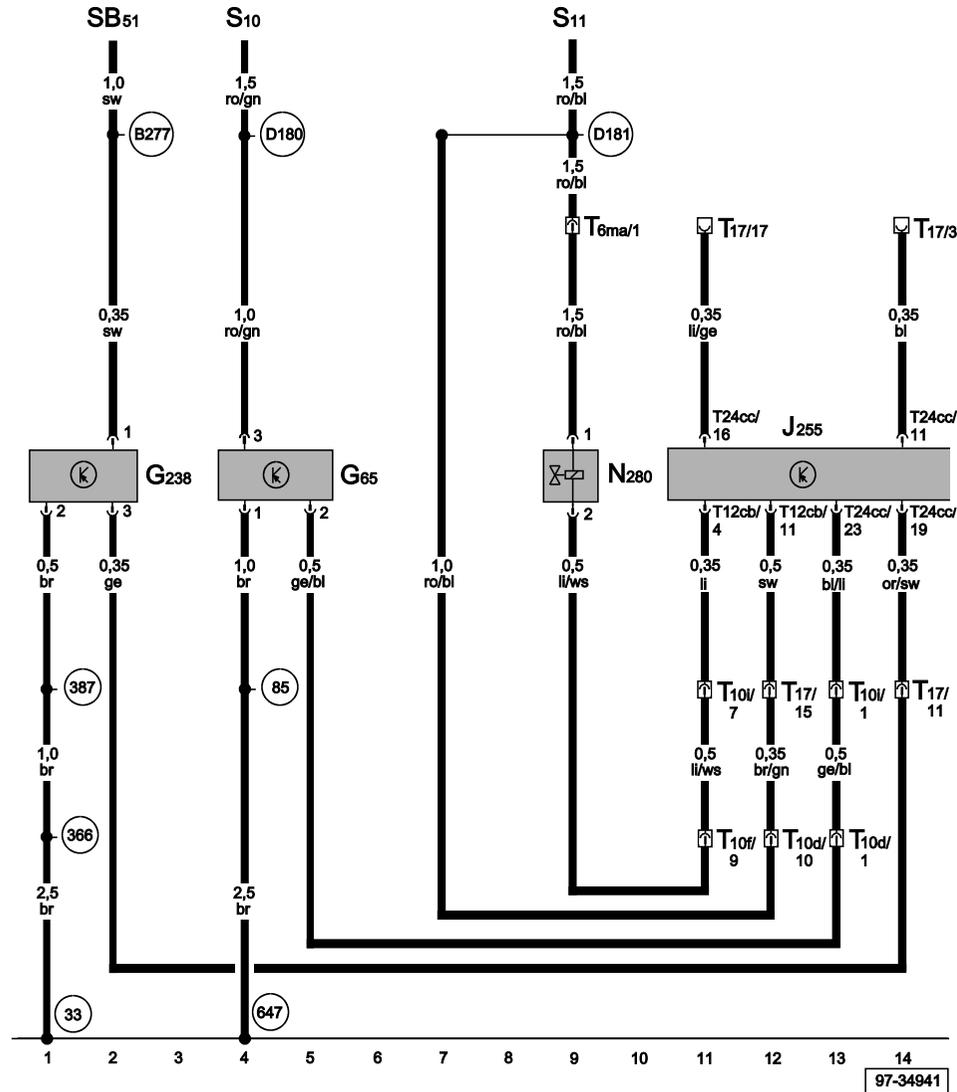
Steuergerät für Climatronic, Hochdruckgeber, Regelventil für Kompressor Klimaanlage
