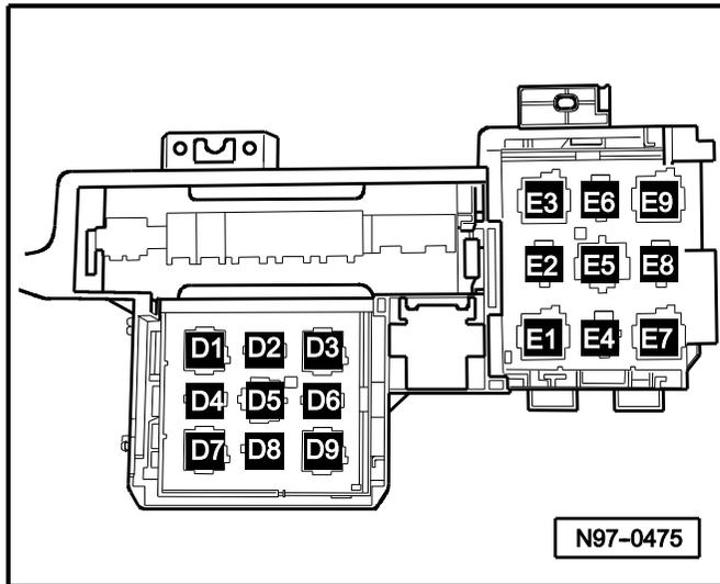
Relaisplatzbelegung in der Versicherungsbox, unter dem Fahrersitz:
