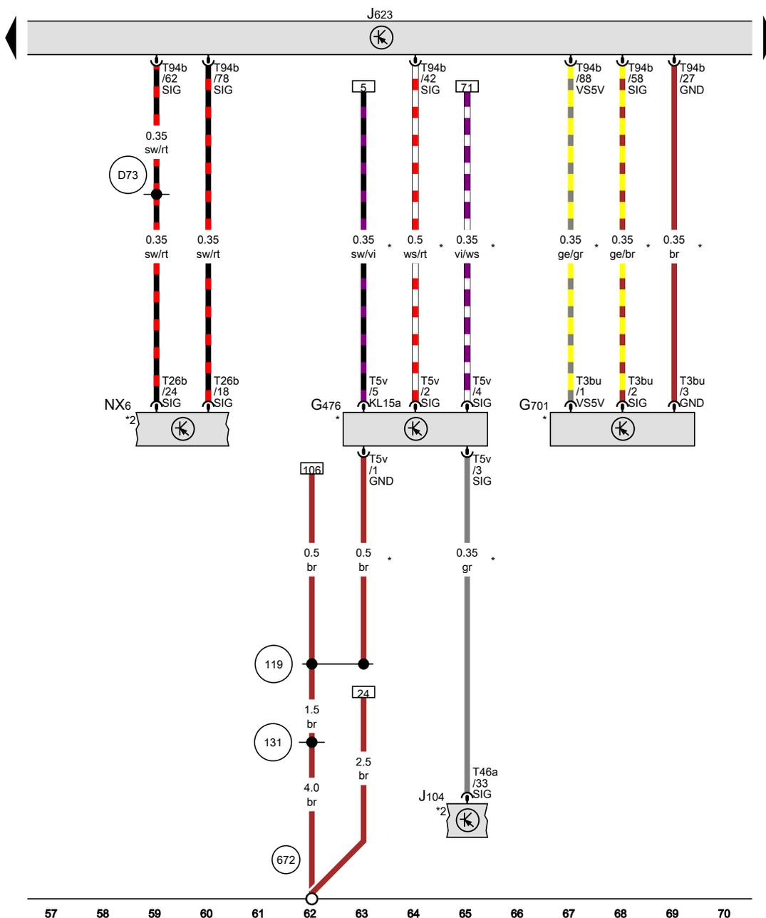
**Kupplungspositionsgeber, Geber für Getriebe-Neutralstellung, Steuergerät für ABS, Motorsteuergerät, Bremskraftverstärker**
