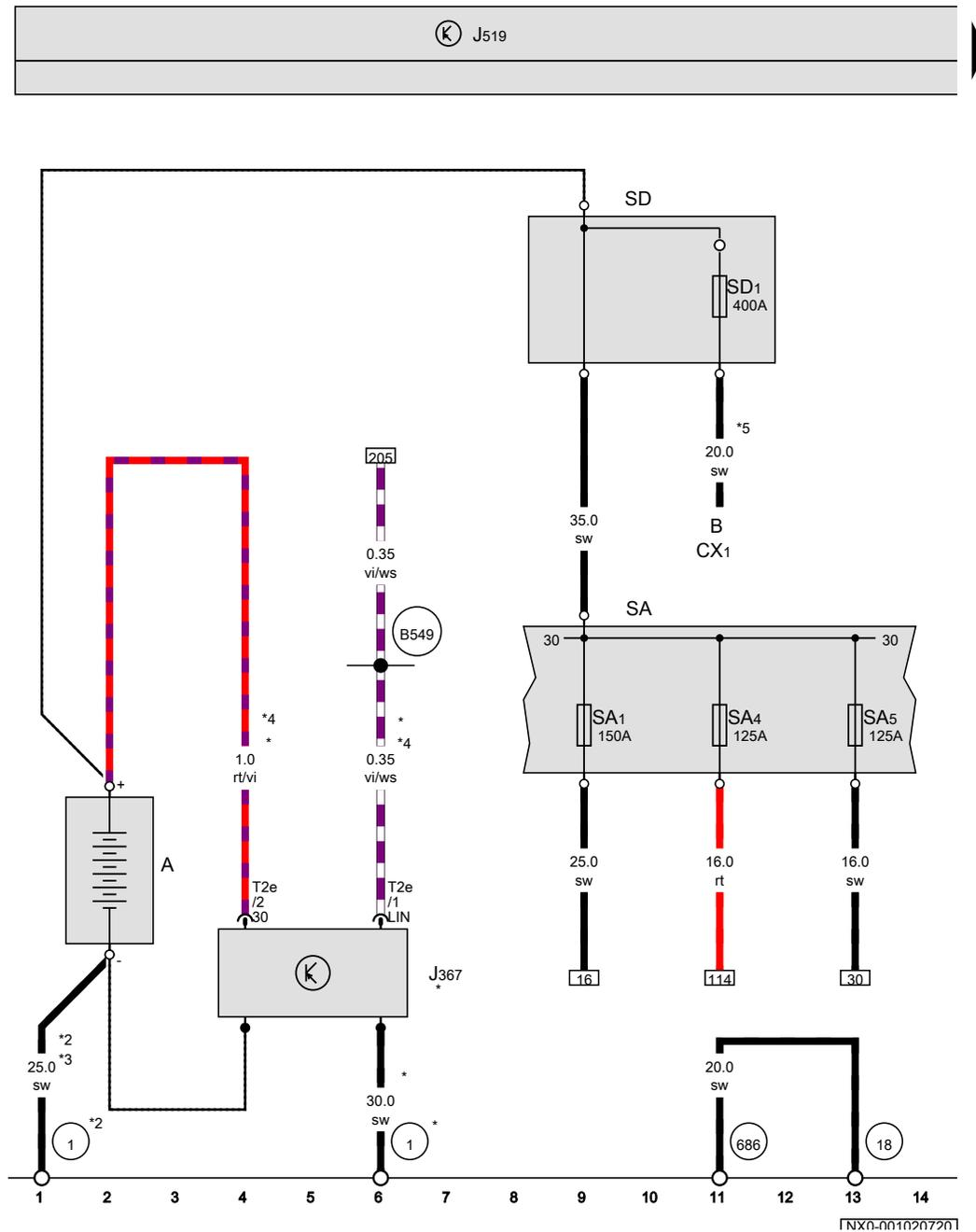
**Batterie, Steuergerät für Batterieüberwachung, Sicherungshalter A, Sicherungshalter D**
