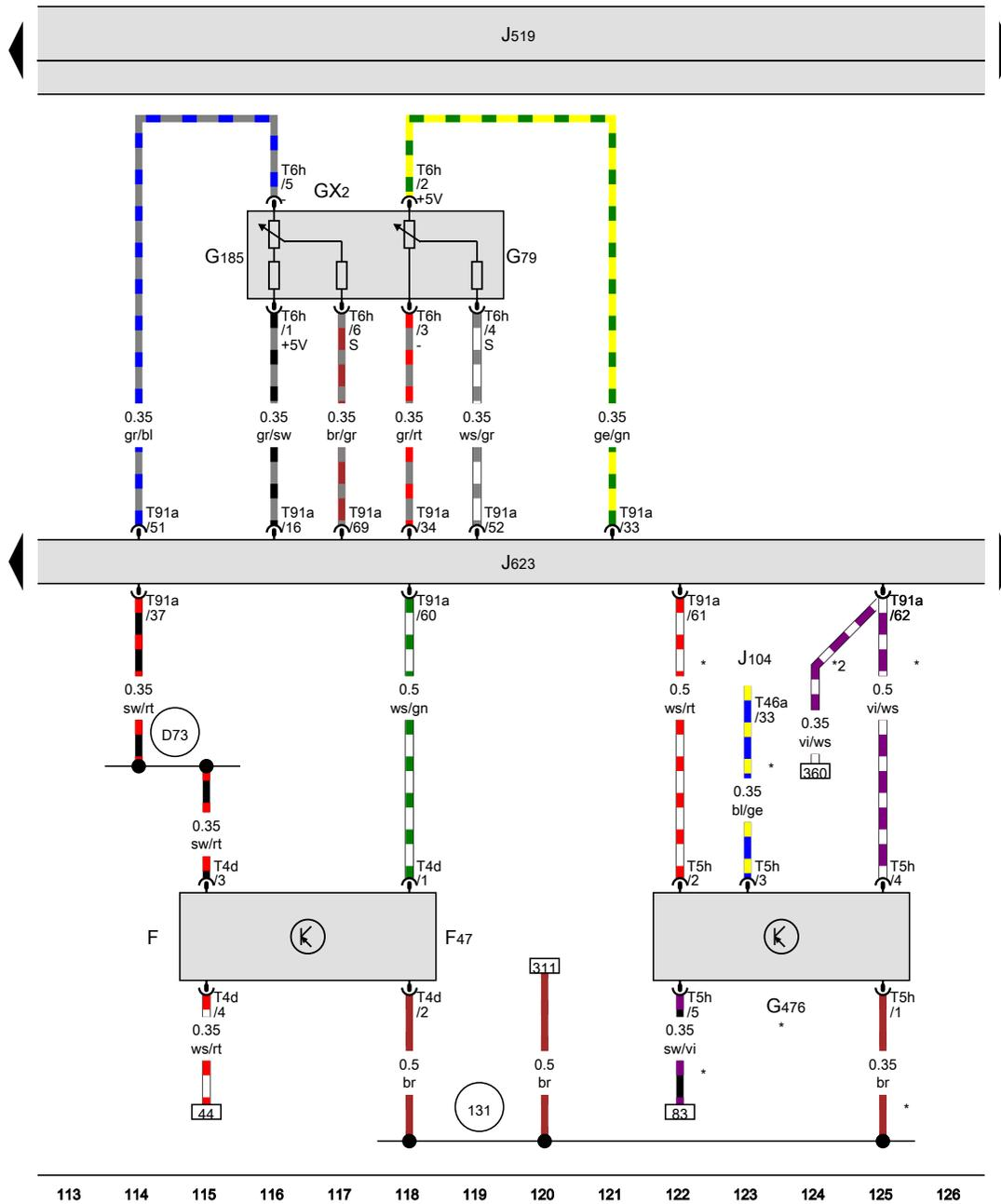
Bremspedalschalter, Gaspedalmodul, Kupplungspositionsgeber, Motorsteuergerät
