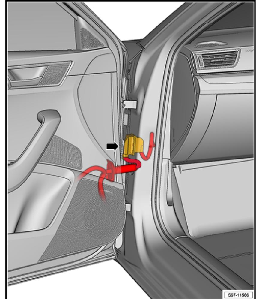
Steckverbindung, 27fach -T27b-, an der A-Säule links, -Pfeil-.
