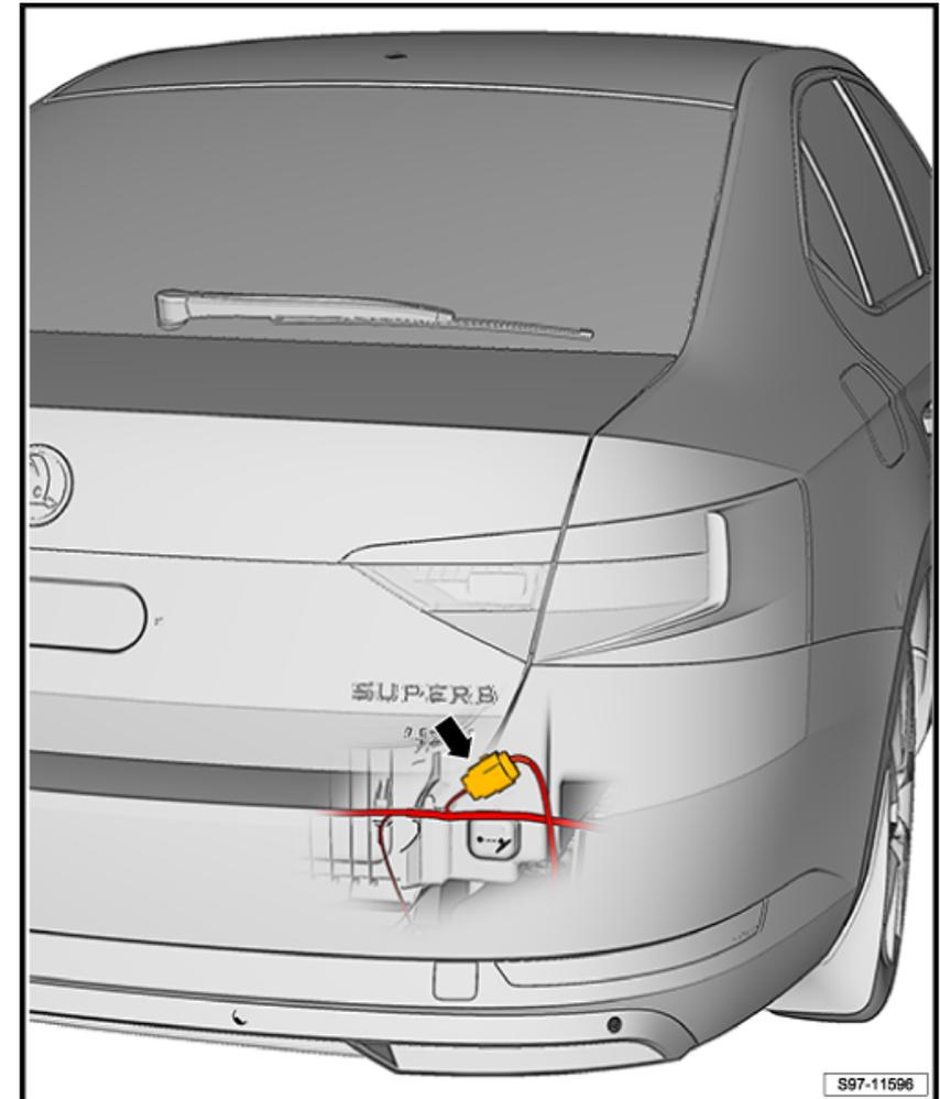
Steckverbindung, 14fach -T14f-, hinter dem Stoßfänger hinten rechts.
