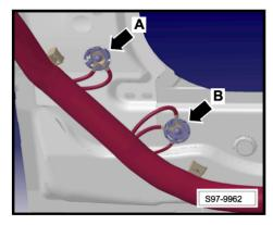
1.4 Übersicht der Massepunkte im Innenraum - Dach (nur für Fahrzeuge mit Linkslenker)
