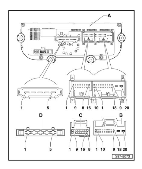
A - Steuergerät für Klimaanlage - J301
