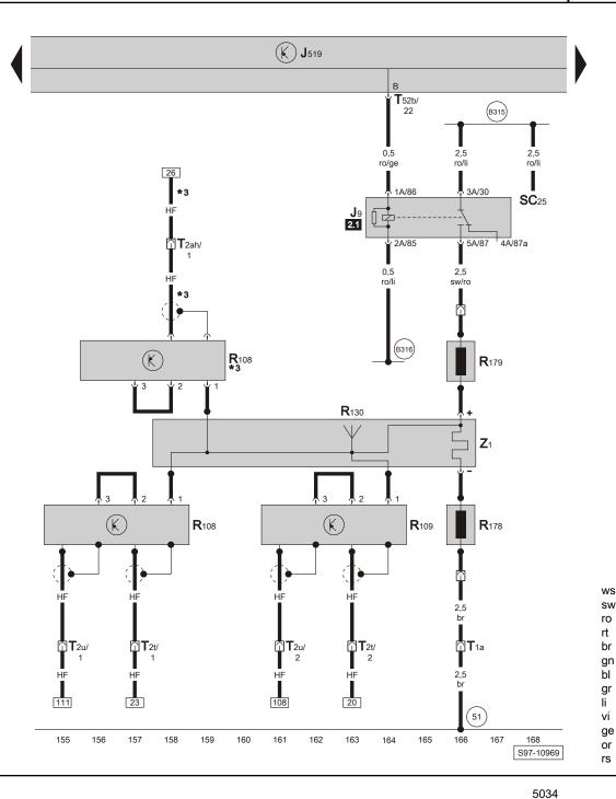
Heckscheibenantenne 1, Antennenmodul links, Antennenmodul rechts, Frequenzfilter für Frequenzmodulation (FM), Relais für beheizbare Heckscheibe, beheizbare Heckscheibe, (gilt für Stufenheck)
