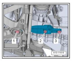
Schrauben -Pfeile- der Verbindungen Kardanwelle/Achsantrieb hinten herausdrehen.
