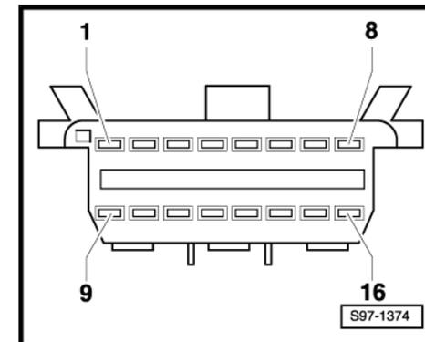
**1.4 Kontaktbelegung des Mehrfachsteckers am Zündanlaßschalter**
