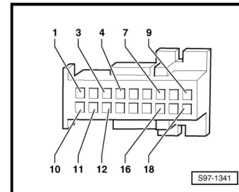
**1.12 Kontaktbelegung des Mehrfachsteckers am Steuergerät - J245-**
