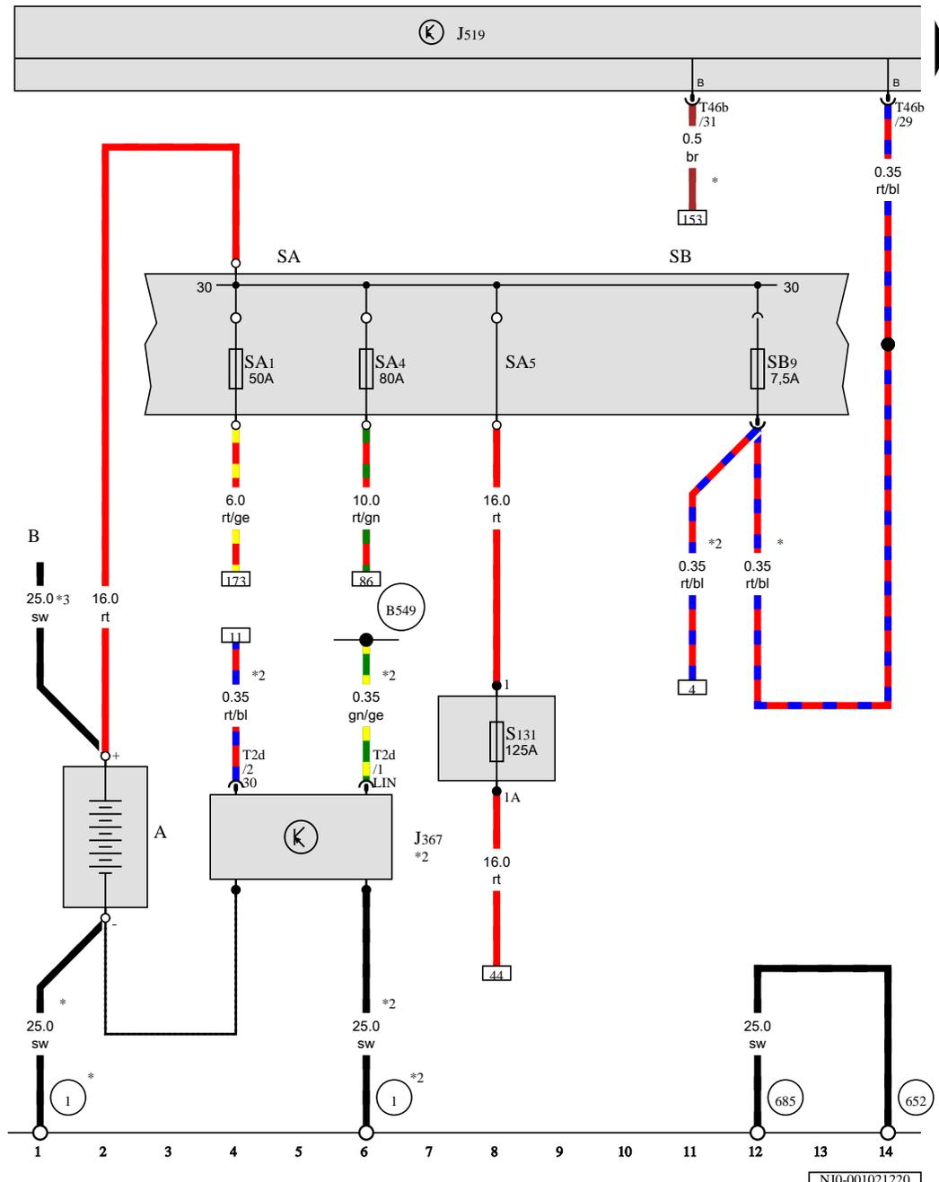
**Batterie, Steuergerät für Batterieüberwachung, Sicherungshalter A, Sicherungshalter B**
