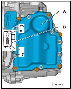
A - Mechatronik für Doppelkupplungsgetriebe -J743-
