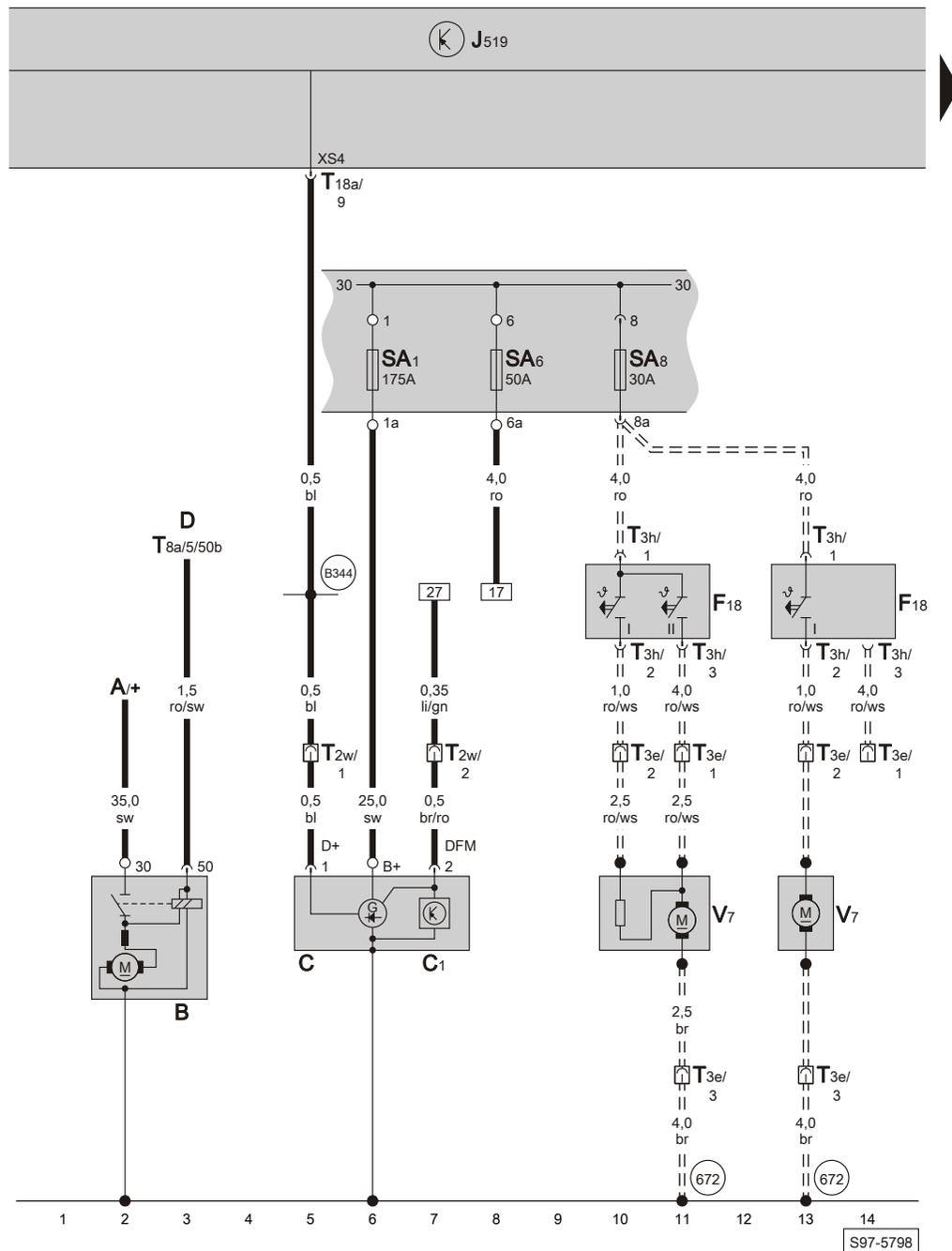
Anlasser, Drehstromgenerator, Thermoschalter für Kühlerlüfter, Kühlerlüfter, Sicherungshalter A auf der Batterie
