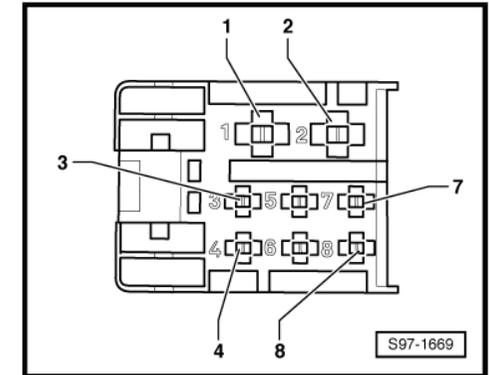
**1.19 Kontaktbelegung Stecker Türsteuergerät vorn rechts, 12-fach**
