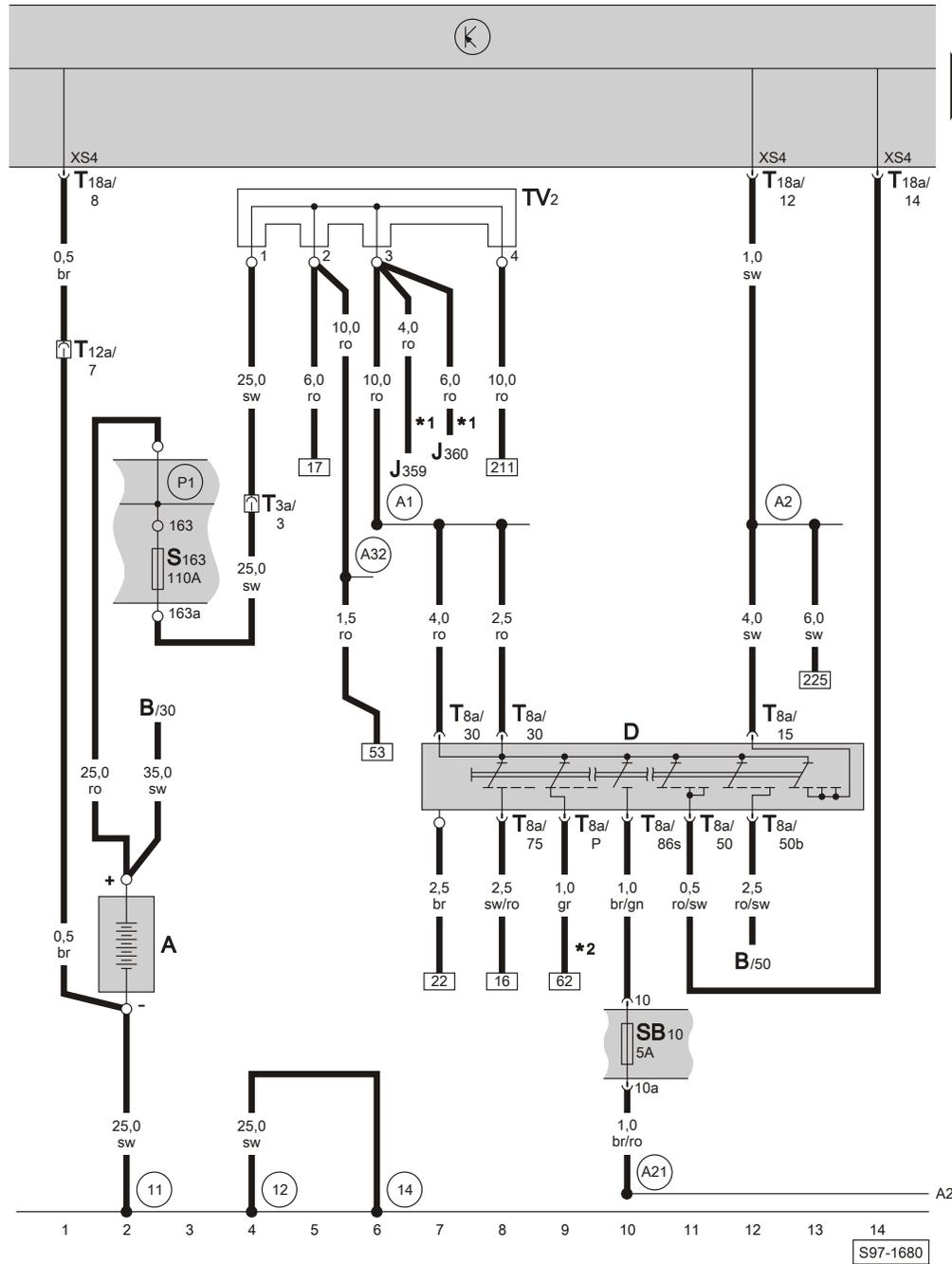
**Batterie, Zündanlaßschalter, Sicherungshalter auf der Batterie, Sicherungshalter**
