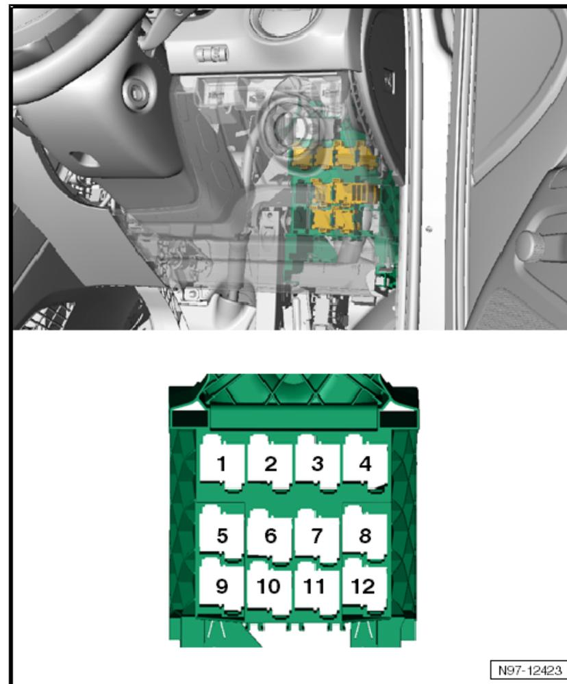
1 - Steuergerät für Kühlerlüfter -J293-
