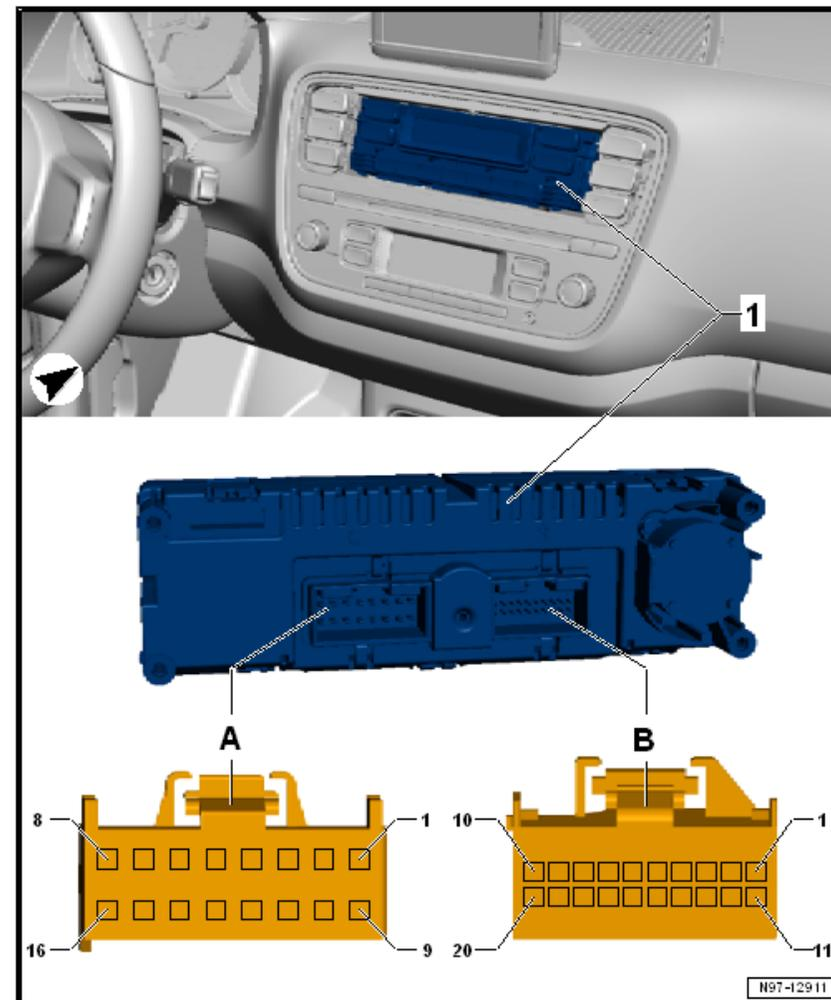
Steckerbelegung Steuergerät für Climatronic -J255-
