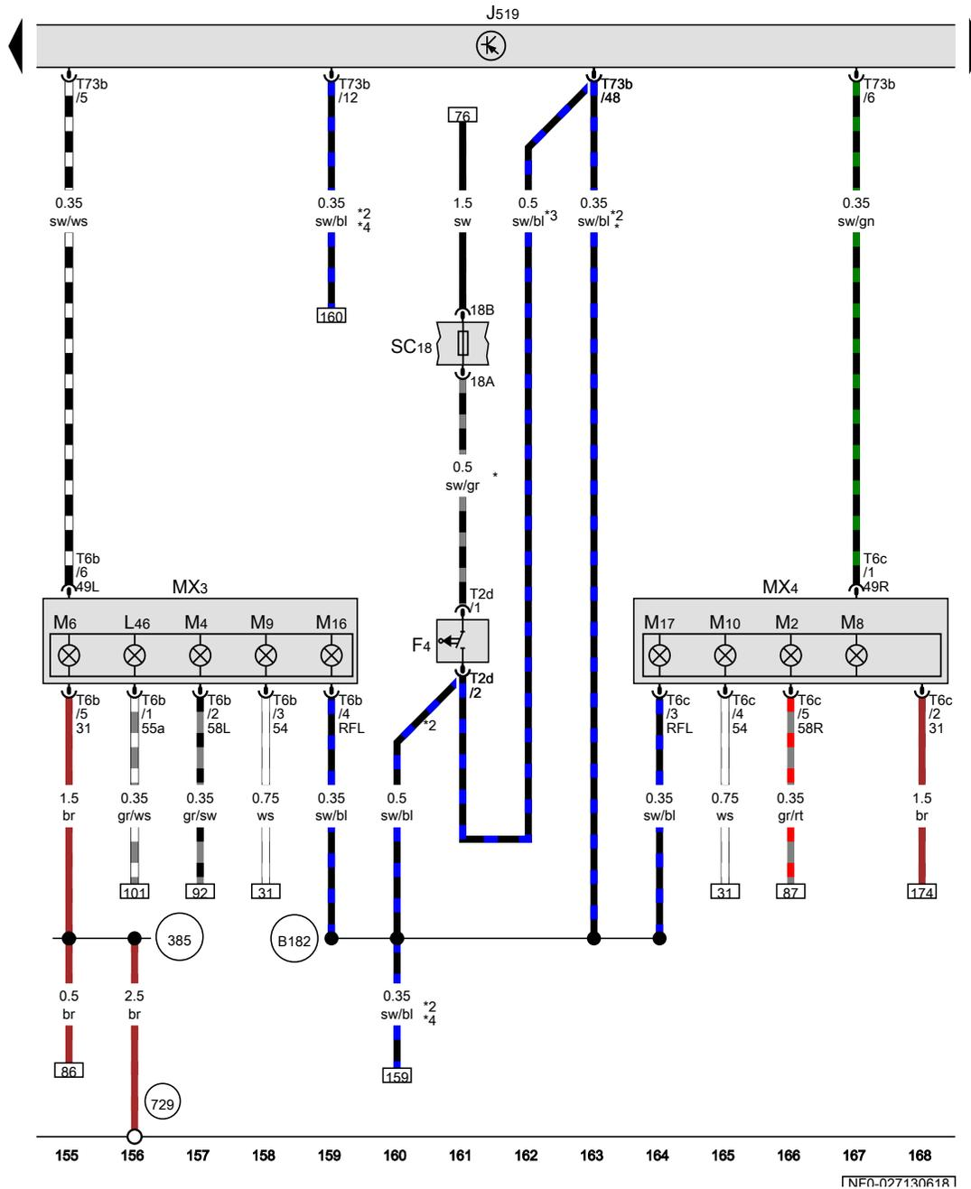
Schalter für Rückfahrleuchten, Bordnetzsteuergerät, Schlussleuchte links, Schlussleuchte rechts
