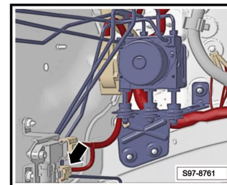
**1.16 Steckverbindung an der Stirnwand rechts (nur für Fahrzeuge mit Rechtslenker)**
