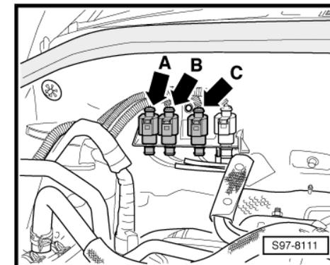
**1.15 Steckverbindung an der Stirnwand links (nur für Fahrzeuge mit Rechtslenker)**
