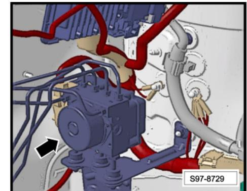
**1.14 Steckverbindungen an der Stirnwand rechts (nur für Fahrzeuge mit Linkslenker)**
