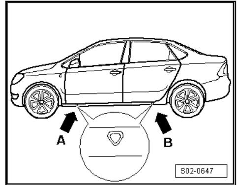
Die Aufbockpunkte befinden sich an der Versteifung des Unterholms im Bereich der Markierung -Pfeil A- und -Pfeil B-, auf der unteren Fläche des Unterholms.
