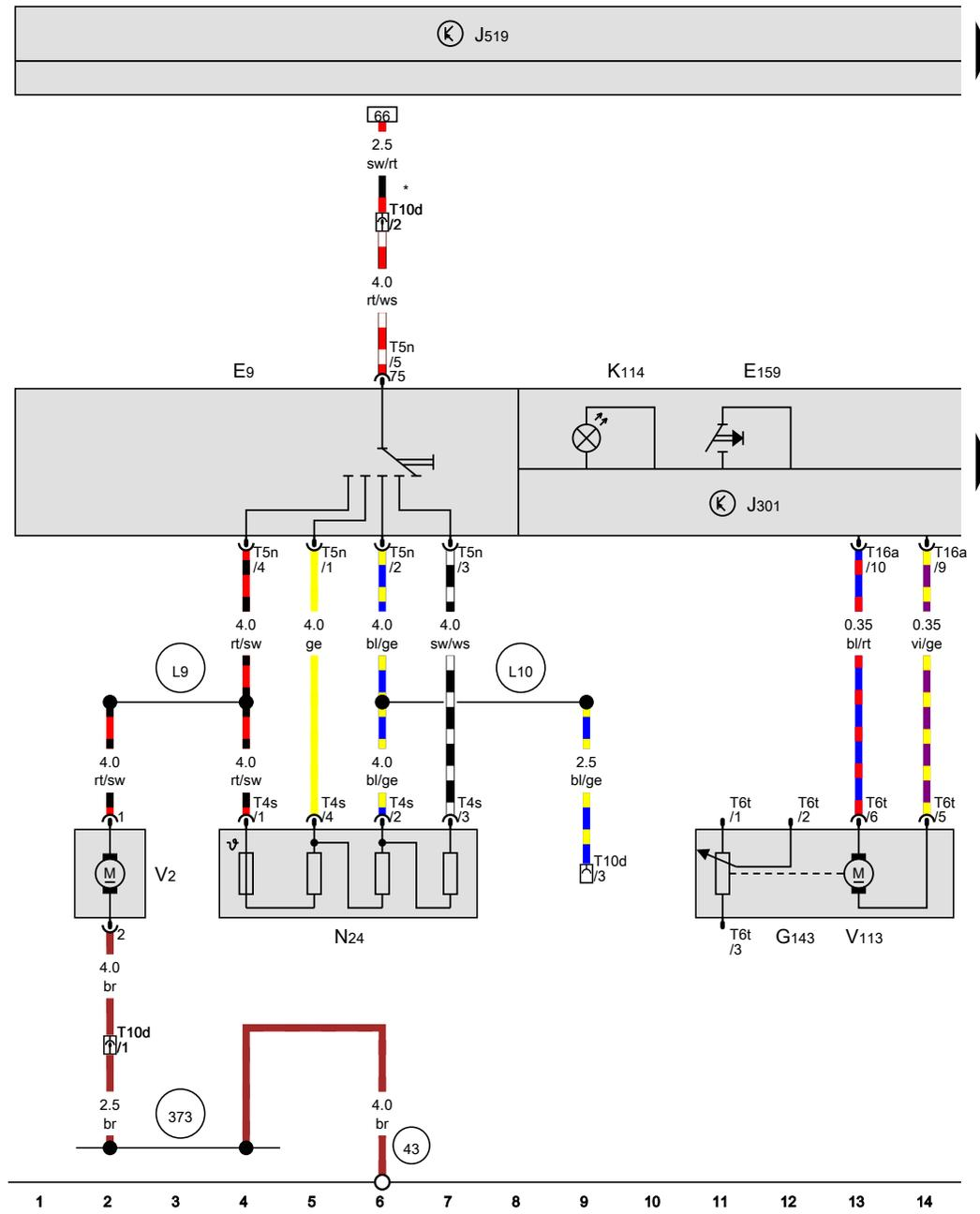
**Steuergerät für Klimaanlage, Vorwiderstand für Frischluftgebläse mit Überhitzungssicherung, Frischluftgebläse, Stellmotor der Umluftklappe**
