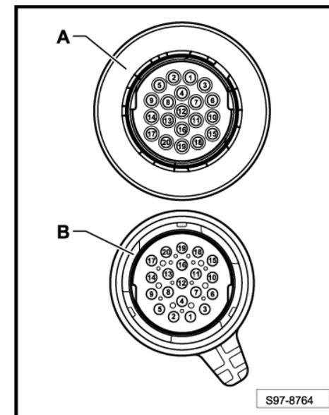
A - Mechatronik für Doppelkupplungsgetriebe -J743-
